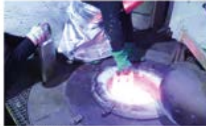
Wlewanie stopu do formy
